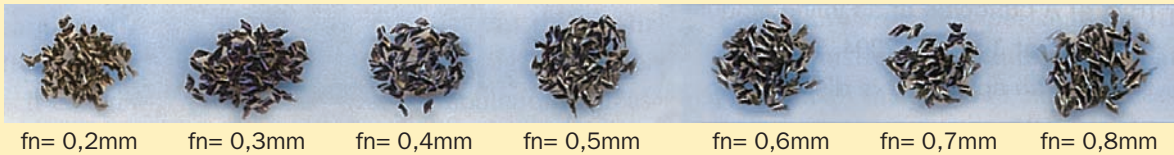
Unterschiedliche Spanformen bei Änderung des Vorschubs eines VHM-Langlochbohrers bei Einsatz von Minimalmengenschmierung.
